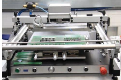
auf die Oberfläche der Leiterplatte bestückt. Das bedeutet dass die Bauelemente wesentlich kleiner werden. War ein herkömmlicher Widerstand etwa noch 8 x 2mm groß so sind Widerstände in SMT nur noch 3 x 1,5 mm groß. Die kleinsten Bauelemente, die unser neuer Automat noch verarbeiten kann sind sogar nur 0,6 x 0,3 mm groß. Diese extrem kleinen Teile, die scherzhaft Vogelfutter genannt werden, werden auf Rollen geliefert
