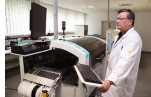
und durch den Automaten angesaugt und genau auf die vorgesehene Stelle positioniert. Dies geht im Sekundentakt. Der Automat vermisst dabei die Bauelemente und deren Position mit Laser gestützter Optik und teilweise sogar die elektrischen Werte.
